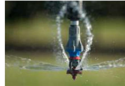
Installés à la place des traditionnels sprinklers, ces arroseurs rotatifs présentent la particularité de fonctionner à faible pression (0,5 à 1,5 bar selon les modèles contre 3 pour les sprinklers).
